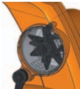
Grâce à une fenêtre transparente, l'opérateur peut regarder à l'intérieur de la chambre de broyage et suivre le processus de broyage. Ce faisant, il peut anticiper les blocages, le bourrage et l'usure des couteaux.
